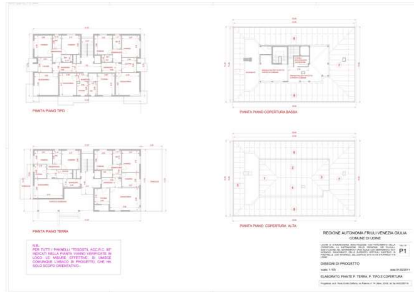
PIANTE PIANO TIPO E INTERVENTO COPERTURE CON POSIZIONAMENTO LASTRE IN TEGOSTIL ISOLATO CON PRODOTTO BAFS .-
